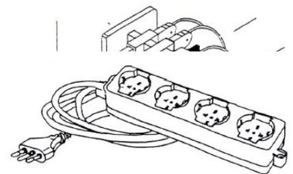
Spine di tipo tedesco (Schuko) possono essere inserite in prese di tipo italiano solo tramite un adattatore che trasferisce il collegamento di terra effettuato mediante le lamine laterali ad uno spinotto centrale. E' assolutamente vietato l'inserimento a forza delle spine Schuko nelle prese di tipo italiano. Infatti, in tale caso dal collegamento verrebbe esclusa la messa a terra.
